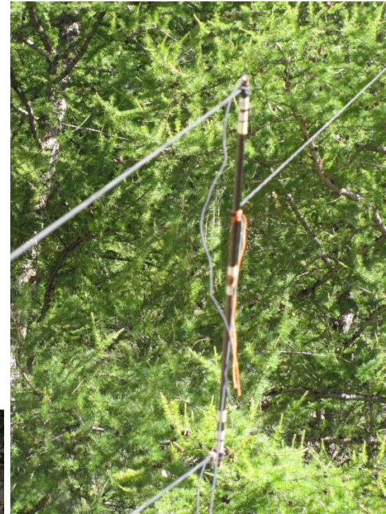
Ecarteur dissymétrique vers contrepoids
