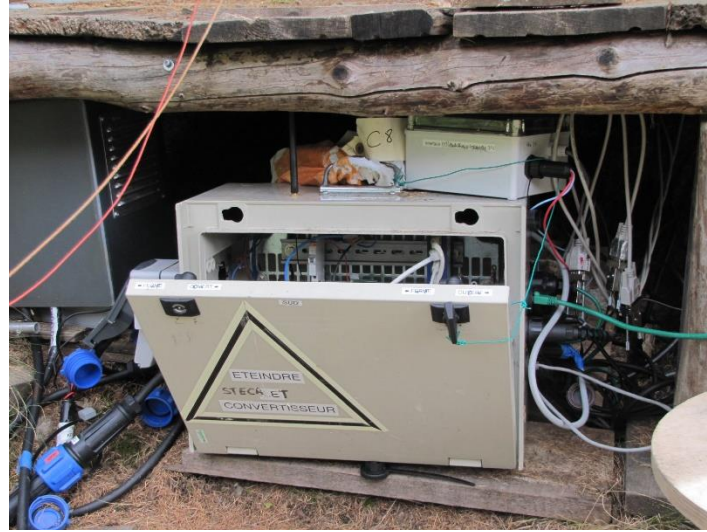
Boitier Sud + boitier Robofocus. Gestion des antennes Sud, Est et Ouest
