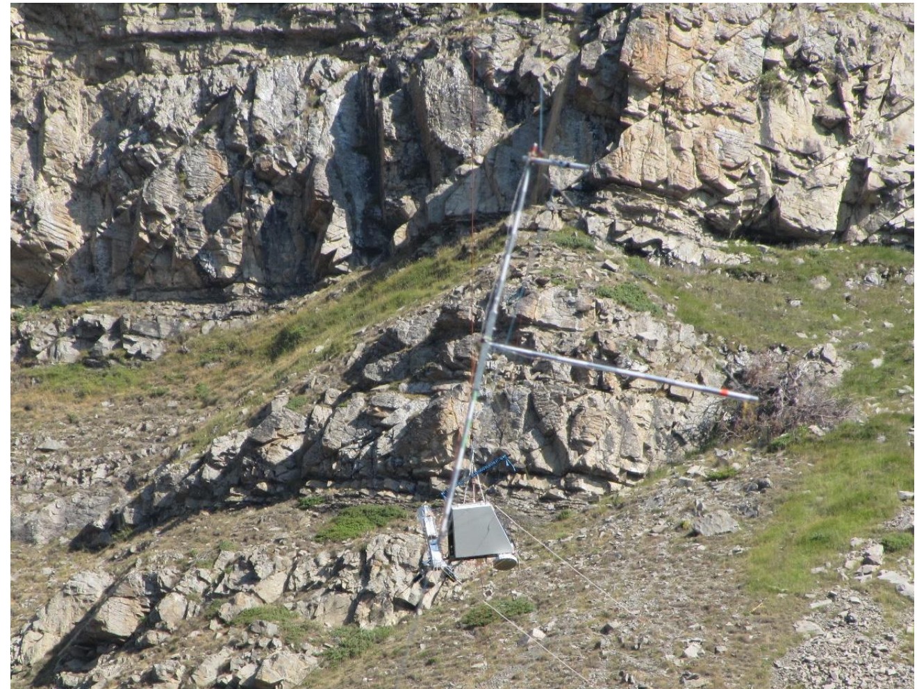
Nacelle vue du Sud depuis Obelix. En premier plan le tetras Sud. Au bout du bras Est, on remarque un arbre mort dans la falaise adret: bon repère grossier d'altitude et de méridien pour la nacelle. On distingue bien les deux fils Est partant vers la droite, le banc optique, le boitier électronique et l'antenne wifi.
